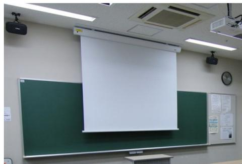
スクリーンは電動式です。プロジェクターのON/OFFに合わせて昇降します。AVコントローラーのボタンによる昇降も可能です。
